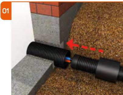
Гофрированная проходная гильза должна быть засементирована в проеме стены (с помощью гидрофобного раствора, в комплект не входит) и должна выступать наружу на расстоянии 10 см от поверхности стены. Термоусадочный рукав оденьте предварительно на кожух трубопровода, без каких-либо разрезов.
