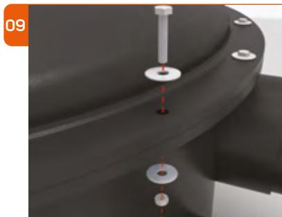
Закройте крышку смотрового колодца и равномерно затяните гайки, болты и шайбы из нержавеющей стали.
