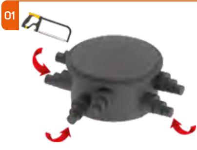
Обрежьте патрубки UIC в соответствии с необходимым диаметром кожуха трубы. Патрубок Ø 120 для кожуха 110 мм, Ø 170 для кожуха 140/160 мм и Ø 235 для кожуха 75/90/200/225 мм. Для кожуха Ø 75 и 90 мм используйте адаптеры RAS200/75 и RAS200/90.
