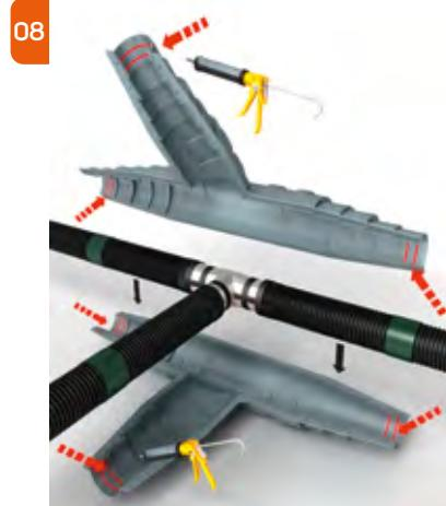
Нанесите две полосы прилагаемого герметика минимальной толщиной 5 мм и шириной не менее 4 мм на всех концах оболочки.
