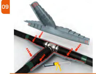
Нанесите герметик в области канавки до тех пор, пока ширина канавки не будет **полностью** заполнена.
