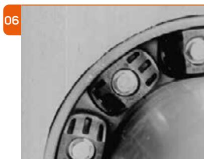
Не затягивайте болты более чем на 4 оборота за раз. Продолжайте движение по часовой стрелке. Сделайте еще 2 или 3 прохода с 3 оборотами на болт, пока звенья не будут равномерно сжаты и не будет достигнут макс. крутящий момент (см. таблицу).
