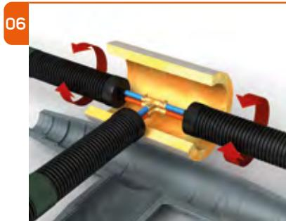
Установите больший сегмент теплоизоляции на основную трубу с помощью самоклеящейся ленты (не входит в комплект). Меньший сегмент изоляции закрепите вокруг отвода трубопровода.
