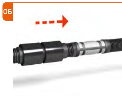
Надвиньте прямую гильзу, пока оба конца предварительно изолированного трубопровода не будут покрыты. Затем надвиньте оба термоусадочных рукава так, чтобы каждый из них наполовину покрывал прямую гильзу и кожух трубопровода.
