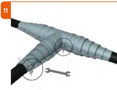
11 Соедините обе половины оболочки с помощью прилагаемых болтов из нержавеющей стали. Все болты следует затягивать до тех пор, пока герметик не выдавится с торцов кожуха.
