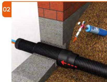
Наденьте термоусадочный рукав на гильзу так, чтобы закрыть и гильзу, и кожух трубы. Мягко нагрейте термоусадочный рукав и обожмите его по всей поверхности, используя защитные перчатки.
